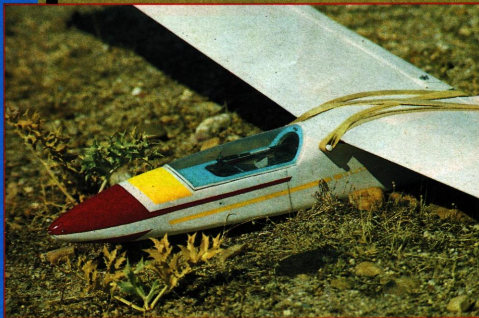
La cabina es de tipo comercial (Llanero), montada sobre contrachapado de 3 mm.
